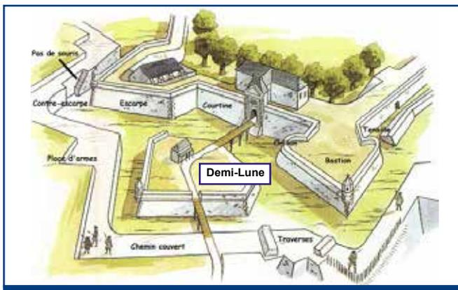
Schéma d'une fortification bastionnée
